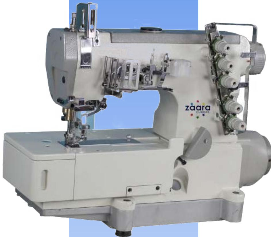
MACHINE PLATE, TROIS AIGUILLES POINT DE CHAÎNE, CINQ FILS, AVEC MOTEUR À ENTRAÎNEMENT DIRECT À ÉCONOMIE D'ÉNERGIE INTÉGRÉ, COUVERCLE INFÉRIEUR ET SUPÉRIEUR, TYPE DE POINT 605, DISTANCE DES AIGUILLES MM 5,6 OU 6,4, AVEC TRANSPORT DIFFÉRENTIEL, POUR COUTURE ORNEMENTALE .
