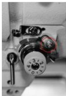
Grâce au capteur de rupture de fil, la machine s'arrêtera automatiquement d'alerter l'opérateur.
