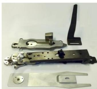
La machine, sur demande, est fournie avec un KIT de bouton d'égout. En remplaçant certaines parties de la pince, il est possible de réaliser des travaux de couture de boutons.
