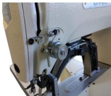
Il est possible de mémoriser plusieurs niveaux de tension en fonction du tissu utilisé. En sélectionnant celui que vous souhaitez, le tendeur de fil électronique ajustera automatiquement la tension du fil.
