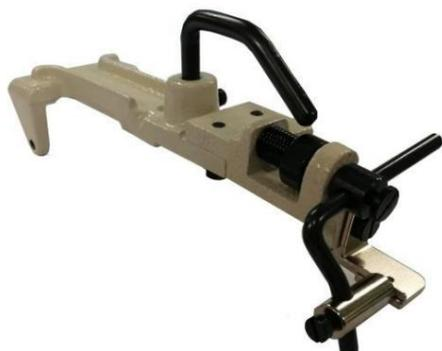
Grâce à la pince interchangeable spéciale (fournie en option), les boutons à queue peuvent également être appliqués sur des tissus. L'opération de remplacement est facile et ne nécessite aucun outillage particulier.
